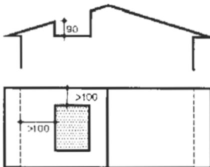
En terrazas deducidas de la cubierta, ésta no podrá interrumpir el caballete de cubierta y el faldón será continuo hasta el antepecho, cuya altura mínima será de 90 cm. y no podrá sobresalir de la cubierta.
